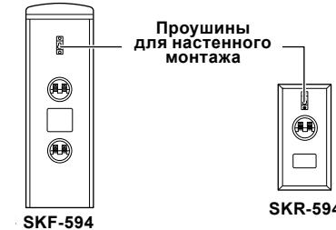
Для горизонтального монтажа центральной акустической системы воспользуйтесь двумя проушинами для акустической системы и двумя надежно закрепленными в стене шурупами.
